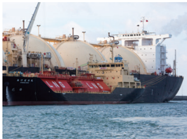
LNG外航船(奥)からLNG内航船「あけぼの丸」(手前)へLNGを直接移送する様子
