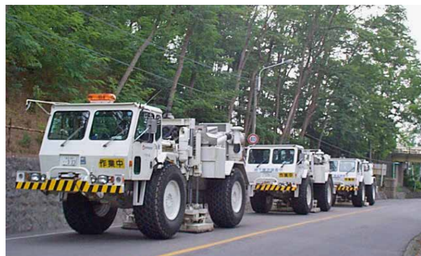
△パイプロサイズ車による陸上弾性波探査の様子
